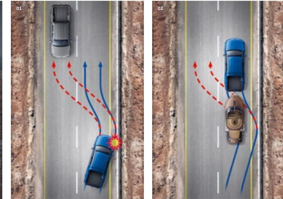
**01 Nouveau système de freinage automatique post-collision.**<sup>4)</sup> En cas de collision, il initie le freinage pour prévenir idéalement les collisions secondaires. Après une courte décélération, le véhicule freine progressivement jusqu'à 10 km/h. Le conducteur peut reprendre le contrôle à tout moment. | CL | CA | AV |
