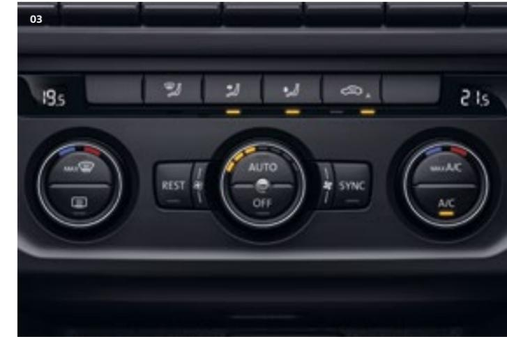
**03 Climatisation « Climatronic ».** Cette climatisation offre deux zones de régulation de température, à l'intention du conducteur et du passager avant, une fonction manuelle de circulation d'air ainsi qu'un capteur de qualité d'air. Le régime de soufflerie varie en fonction de l'ensoleillement et de la température extérieure. | CL | CA | AV |
