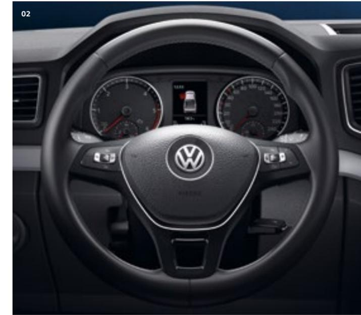
**02 Volant cuir multifonction avec palettes.** Ce volant offre une excellente tenue en main et des commandes très conviviales. Avec les palettes, vous pouvez commander par exemple la radio et le système de navigation ou votre mobile. Avec les palettes ergonomiques, vous découvrez la joie des passages de rapports très sportifs. | CL | CA | AV |
