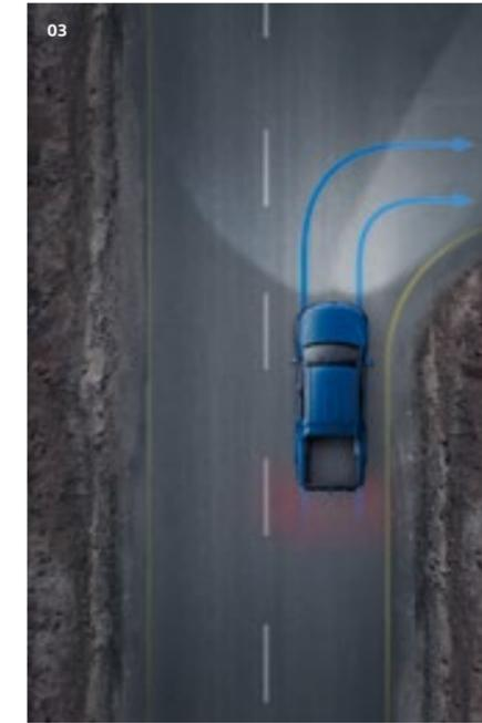
**03 Projecteurs antibrouillard avec éclairage statique d'intersection.** Ils vous assurent une visibilité optimale par mauvais temps. Lors des changements de direction, le projecteur situé à l'intérieur de la courbe éclaire le bord de la route. | CL | CA | AV |
